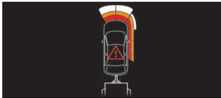
i 제조사 지침에 따라 트레일러 또는 자전거 캐리어가 견인 차량에 장착된 경우, 후방 주차 센서 시스템은 자동으로 해제됩니다. 이때, 트레일러 외곽선이 차량 이미지 뒤쪽에 표시됩니다.
