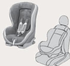
“앞을 향하는” 위치로만 장착됩니다. 상단 스트랩을 사용하여 고리 A 및 상부 고리 B(탑 테더)에 부착됩니다. 프론트 승객석 시트 또는 뒷좌석 외측 시트에만 장착됩니다. 차량의 시트 헤드레스트를 탈거해야 합니다.
