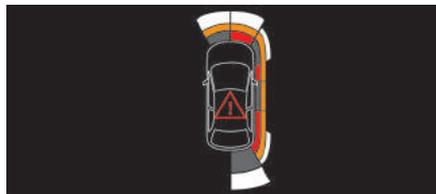
이 시스템은 앞/뒤 범퍼 측면에 위치한 4개의 추가 센서를 통해 차량 조작 중 고정된 장애물의 위치를 기록하여 장애물이 차량 측면 옆에 있는 경우 해당 위치를 표시합니다.
