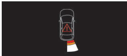
이 기능은 차량 궤도를 고려하지 않고 장애물과 차량 간 거리를 표시하는 막대기를 화면에 표시하여 청각 보조 기능을 보완합니다(흰색: 더 멀리 위치한 장애물, 주황색: 가까이 위치한 장애물, 빨간색: 매우 가까이 위치한 장애물).
