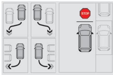
☞ 차량 정지 요청이 표시될 때까지 매우 느린 속도로 이동합니다. 그러면 “Stop the vehicle”(차량 정지) 및 “STOP”(정지) 표시가 나타나고 신호음도 울립니다.
